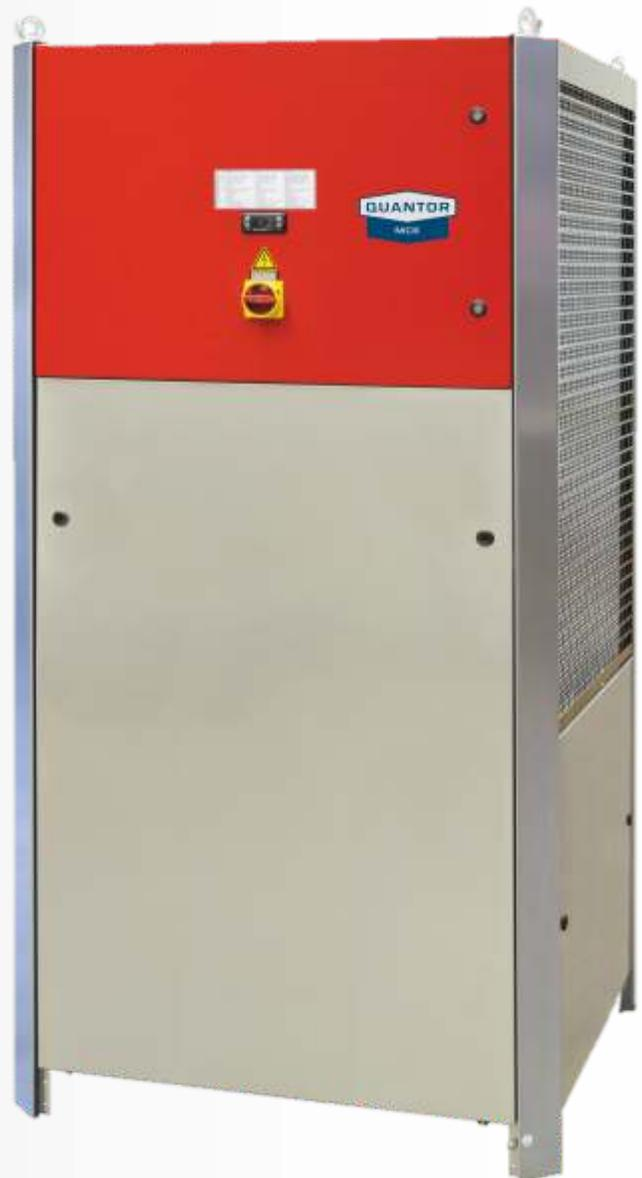
Nuestros refrigeradores de agua **MCK** están compuestos por una unidad de frío en la parte superior y una bomba con un depósito aislado de acero inoxidable en la parte inferior. La unidad está convenientemente construida con una estructura de paneles laterales desmontables, permitiendo así un acceso cómodo a los componentes internos de la unidad. El ventilador está montado en la parte superior, enviando el aire caliente hacia arriba.
